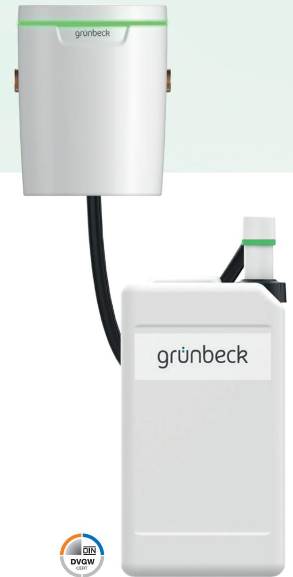
Bei der Baureihe **exaliQ:SC** handelt es sich um Saugglanzengeräte, bei denen der Dosierbehälter neben der Anlage separat am Boden aufgestellt wird. Die Mineralstofflösung wird mittels Saugglanze aus dem Behälter entnommen und durch die Pumpeneinheit des exaliQ in die Rohrleitung dosiert.
