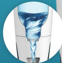
Grünbeck-Vortex-Technologie zur rückstandslosen Filterreinigung durch Wasserverwirbelung.
