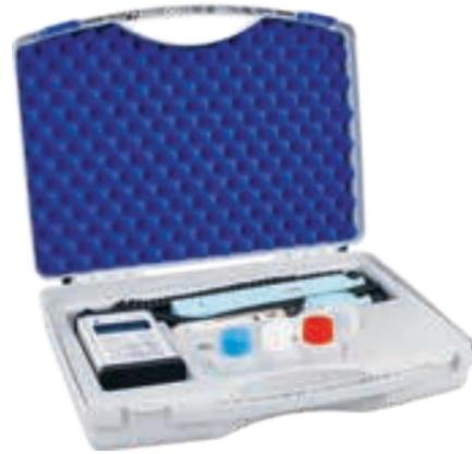
Digital-Hand-Messgerät pH, Leitfähigkeit und Temperatur
