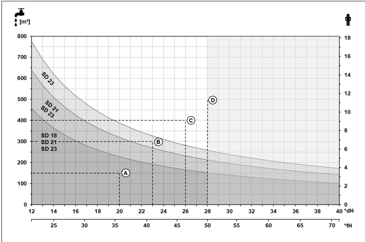
Das Diagramm zeigt die Arbeitsbereiche der Enthärtungsanlagen softliQ:SD. Es gilt für die Enthärtung auf eine empfohlene Weichwasserhärte von 4 °dH.
