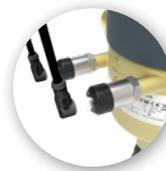
Der Automatikfilter MRA kann um ein **Drucksensoren Zubehör-Set** erweitert werden, welches den Druck vor und nach dem Filter erfasst. Eine Rückspülung wird automatisch ausgelöst, wenn der Wasserdruck durch die Verschmutzung des Filters abnimmt. Eine Warnmeldung bei fallendem Systemdruck bietet zusätzliche Sicherheit für nachgeschaltete Anlagen. Der Grenzwert ist individuell einstellbar. (Bestell-Nr. 107000160000)
