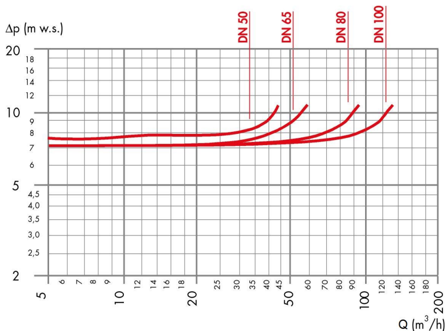
Fig. C-6: Curva della caduta di pressione 2 disconnettore Euro GENO-DK 2-Maxi
