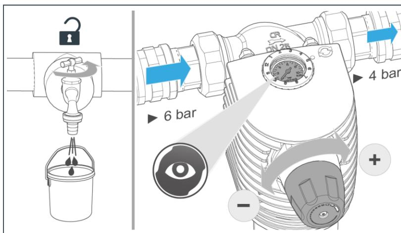
1. Impostare la pressione a valle desiderata sul volantino del riduttore di pressione (ruotando a destra=augmenta la pressione, ruotando a sinistra=si riduce pressione).
