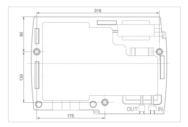
► Monter l'appareil de mesure pour le contrôle de la dureté softwatch sur une surface de mur plane ou sur un châssis de cadre.
