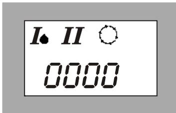
Die Nummer des werkseitig eingestellten Datensatzes (Standard-Betriebsparameter) wird angezeigt. Sofern die Einstellung nicht dem Datensatz Ihrer Anlage (vgl. Kapitel E) entspricht, ist sie anzupassen.
