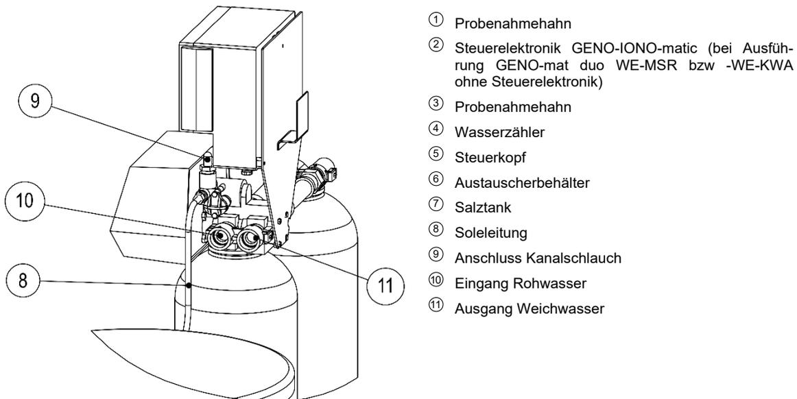
Abb. D-1 (b): Enthärtungsanlage GENO-mat-duo WE;
