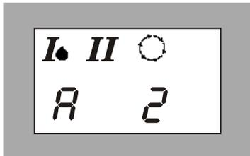
Die Anzeige A 2 steht für eine Anlage mit zwei Austauschbehältern. Bei Anlagen mit einem Austauscherbehälter ist die Anzeige A 1. Die Einstellung ist bei Bedarf anzupassen.
