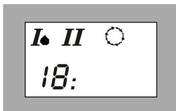
Im Grundzustand zeigt das Display den Betriebszustand der beiden Austauscherbehälter und die im System gespeicherte Uhrzeit an. Zunächst ist die Bediener-Programmier Ebene aufzurufen.
