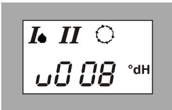
Das Display zeigt den Menüpunkt „Verschnitthärte“. Bei Anlagen ohne Verschneideeinrichtung oder mit einem vor der Verschneideeinrichtung eingebauten Wasserzähler ist hier 0 °dH einzugeben. In allen anderen Fällen ist die Verschnitthärte einzustellen, die durch die Einstellung des Verschneideventils vorgegeben ist (zwischen 0 °dH und Rohwasserhärte). Bei der Enthärtung von Trinkwasser sind die Vorgaben der Trinkwasserverordnung zu beachten (siehe auch Kapitel E).
