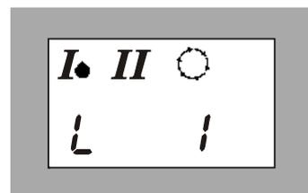
Zunächst kann die „Sprache“ gewählt werden, d. h. die Einheit in der die Anlage künftig rechnet und die Betriebsparameter anzeigt. Zur Wahl stehen L 1: °dH, L 2: °fH und L 3: mol/l (Anzeige mol). Falls keine Änderung notwendig ist, mit Schritt 7. fortfahren.
