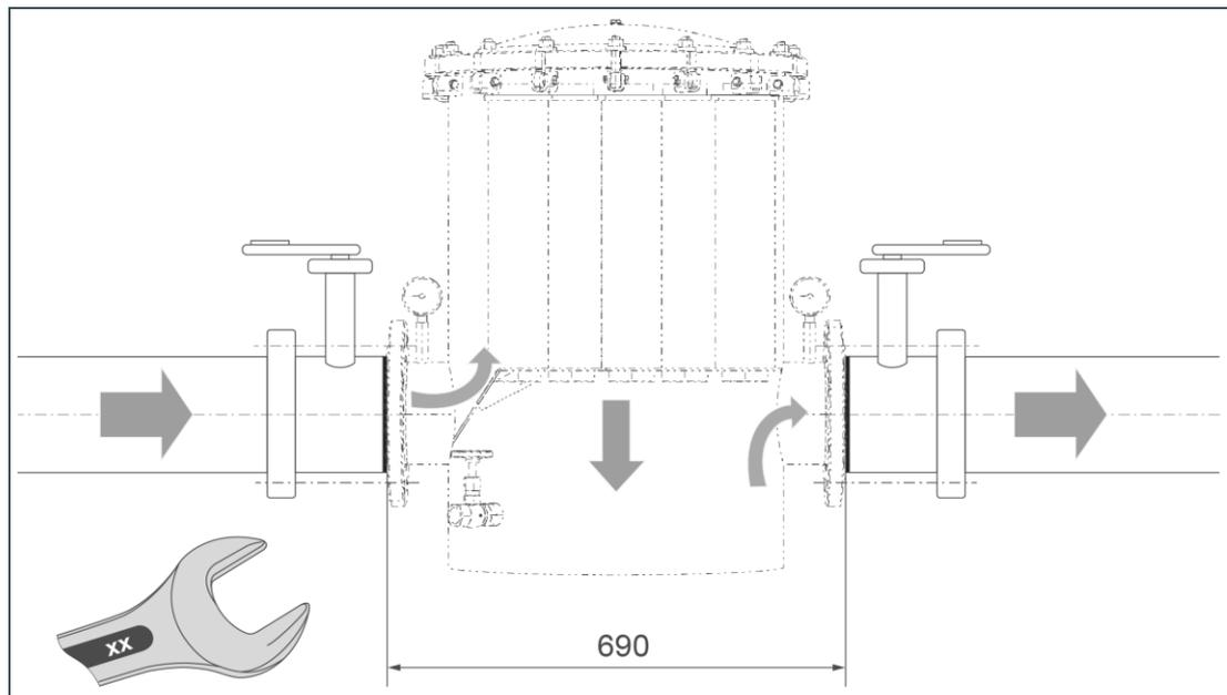
1. Preparare la tubazione con il collegamento a flangia in base alle specifiche della norma DIN EN 1092-1.
