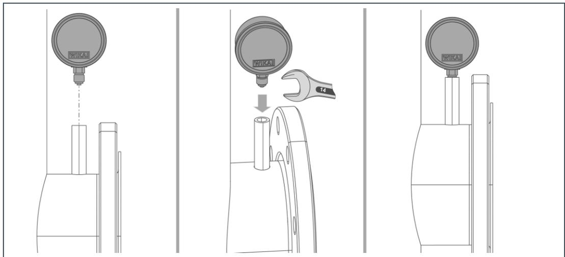
1. Avvitare i manometri alle flange sulla parte superiore del tubo di supporto.
