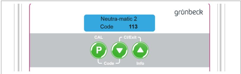
► Programmare i parametri tramite il livello codice 113 nella misura necessaria.
